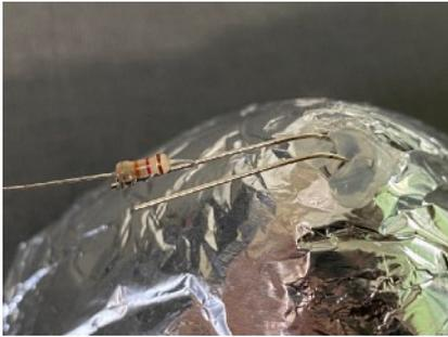
9) Solde ou emende um fio comprido (pode ser qualquer fio elétrico) na outra "perna" do LED e outro fio na ponta do resistor (marque de alguma forma qual dos fios está ligado no resistor e qual está ligado direto no LED).
